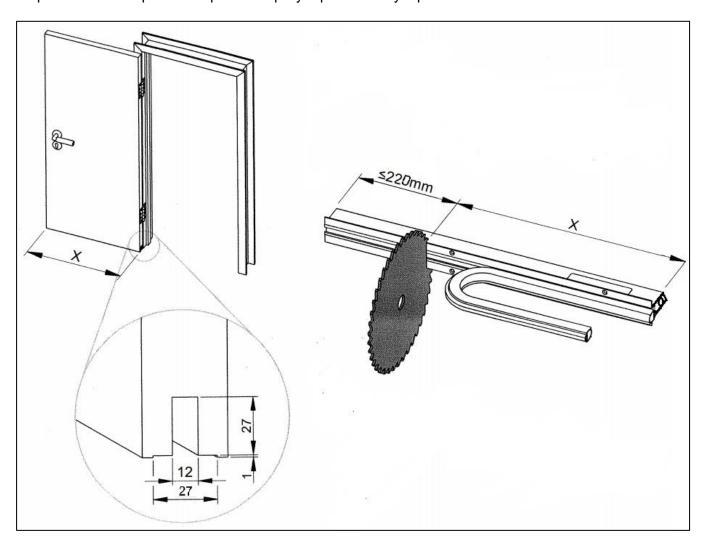
Извлечь уплотнитель из внутреннего зажимного профиля (внутренний зажимной профиль можно извлечь из направляющего профиля). Отпилить порог до нужной длины (отпилить не более 220 мм). Внутренний зажимной профиль должен быть короче направляющего профиля на 3мм. Зачистить напильником торцевую сторону отпила. Вставить уплотнитель в зажимной профиль. Отрезать уплотнитель до нужного размера, но оставить запас с каждой стороны (размер A, B).
