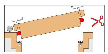
Установить порог в паз на нижнем торце двери. Зафиксировать порог с помощью крепежных саморезов снизу, к торцевой стороне двери.
