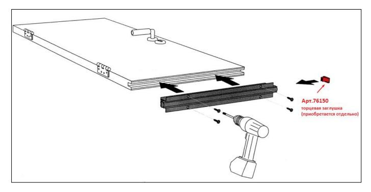
Прикрепите запорную планку к дверной коробке крепежным саморезом из комплекта.
